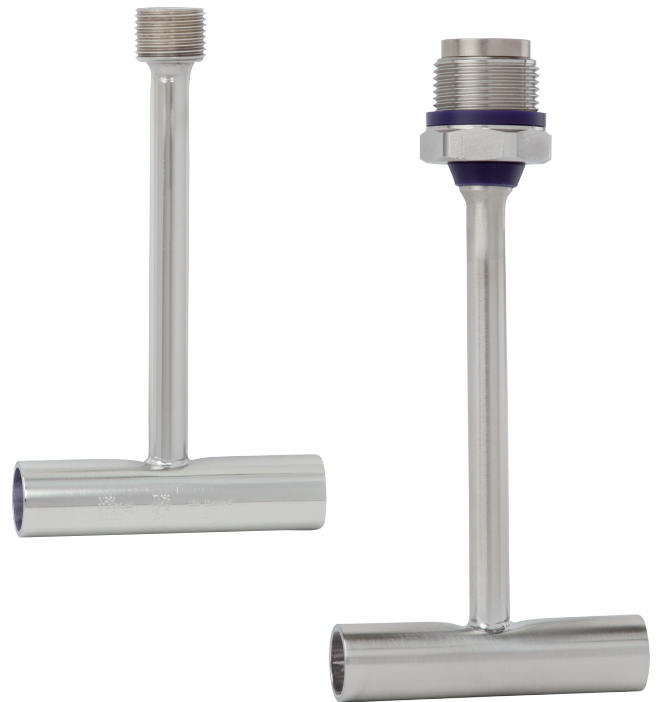
Рис. слева: резьба G 3/8 для модели TR21-B Рис. справа: резьбовое присоединение M24 для модели TR22-B Аксессуары: Система уплотнений на удлинительной шейке
